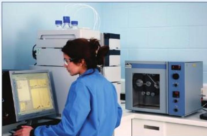
HPCCC高效逆流色谱系统可以配置一个或多个通用液相色谱检测器，包括紫外（UV），蒸发光散射检测器（ELSD）和质谱检测器（MS），用于检测和鉴别所有潜在的化学组分。当然也可以选配自动进样器和馏分收集器。DE公司提供了多种选择方案，适用广泛的应用范围，满足客户的各种预算要求。
